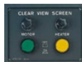
PANNELLO CON FUSIBILI PER AZIONAMENTO MOTORE E RISCALDATORE. PANEL WITH FUSES AND SWITCHES FOR MOTOR AND HEATER.
